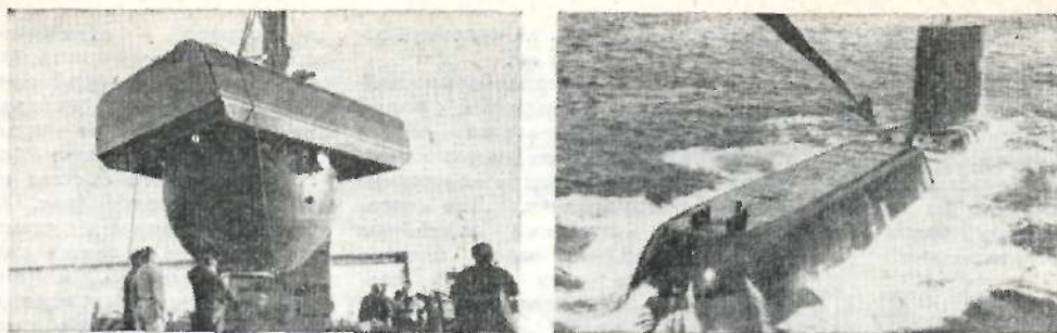
Рис. 4. Спасательная камера и место ее размещения на подводной лодке (указано стрелкой)
